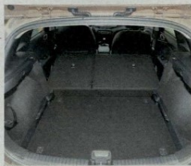
Pojemny kufer 395 l. Podłoga w górnym ustawieniu tworzy płaską powierzchnię
